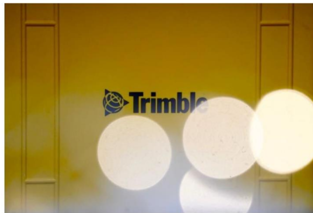
Рисунок 8б. Показаны те же яркие источники света, что на Рисунке 8а, но теперь камера сфокусирована на намного большее расстояние. Заметьте, что изображения источников света расширились в яркие диски из-за расфокусировки.
